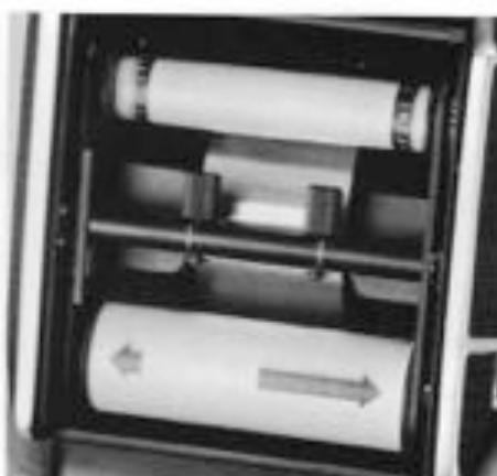
f. Tourner la manivelle d'armement et avancer l'amorce papier jusqu'au point de départ du film (repéré par deux flèches sur le film) et aligner ces flèches sur le repère rouge grainé sur le porte bobine.
