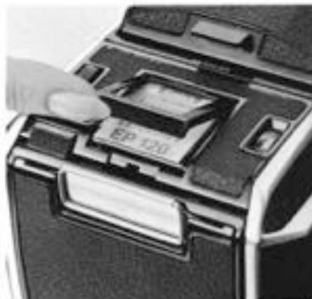
i. Lorsque le film est chargé, détacher le volet de la boîte d'emballage vide et l'insérer dans la fenêtre du dos magasin prévue à cet effet. Ceci vous indiquera quel est le type de film utilisé, en particulier lorsque l'on utilise plusieurs dos magasin.
