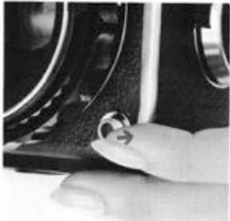
b. Bouton de contrôle de la profondeur de champ Lorsque vous désirez contrôler la profondeur de champ, il suffit d'appuyer sur le bouton correspondant (voir photo). A ce moment, l'iris se fermera au diaphragme préélectionné et vous pourrez contrôler la netteté du sujet, du premier et du second plan. Dès que vous relâchez ce bouton vous retrouvez la pleine ouverture.
