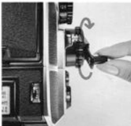
h. Pour amener le film à la première vue. Tourner la manivelle jusqu'à ce qu'elle se bloque. Cela fait avancer le film, arme l'obturateur et en même temps fait avancer le compteur de 0 à 1.
