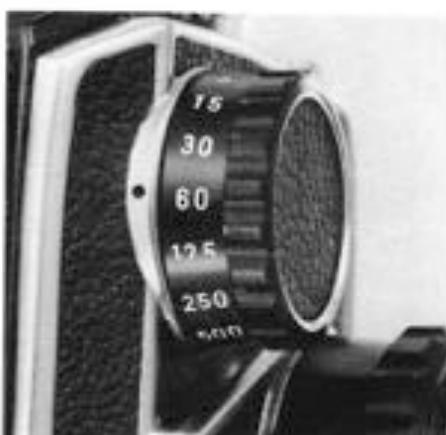
b. Les chiffres des vitesses d'obturation sont gravés en jaune, rouge et blanc. Les vitesses jaunes dépassent 1 sec. Le chiffre rouge 1/60 indique la vitesse pour la synchronisation du flash électronique. Les autres chiffres sont blancs (voir Flash p. 24).
