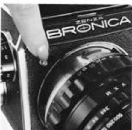
c. Pour enlever l'objectif de la grande monture baïonnette, appuyer sur le bouton de verrouillage de la monture hélicoïdale et tourner l'objectif dans le sens inverse des aiguilles d'une montre, puis retirer le.
