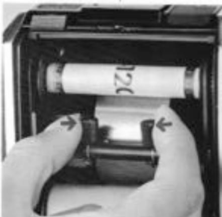
e. Replacer le porte bobine en appuyant sur les deux ergots de l'axe central comme indiqué sur la photo. Le porte bobine est en position correcte si les repères blancs de l'axe central se trouvent au centre de la base des ergots.
