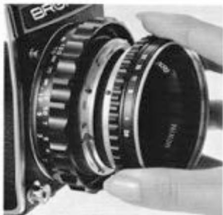
b. Pour monter l'objectif, tourner la rampe hélicoïdale dans le sens des aiguilles d'une montre, aligner le point rouge de l'objectif sur celui de la monture, et tourner l'objectif dans le sens des aiguilles d'une montre jusqu'au déclic de blocage.
