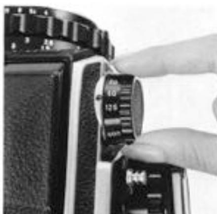
\* Si vous déclenchez avec le sélecteur sur une vitesse intermédiaire, l'obturateur restera ouvert et l'armement ne sera pas possible en passant à la vue suivante. Dans ce cas, la pile se décharge. Pour remédier à cela, régler correctement le sélecteur, veiller toujours à ce que le sélecteur soit correctement positionné.
