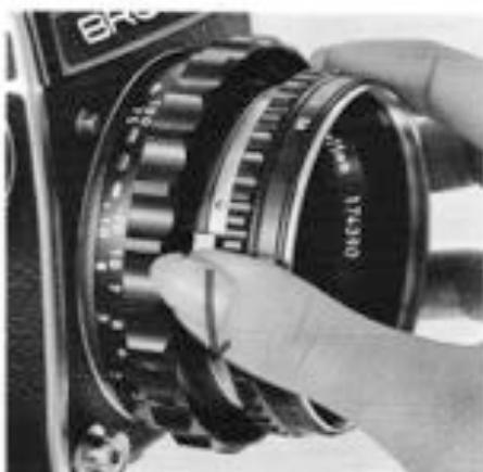
c. Pour retirer l'objectif, tourner la rampe hélicoïdale dans le sens des aiguilles d'une montre, appuyer sur le levier de verrouillage situé sur le côté gauche de l'objectif, tourner l'objectif vers la gauche (dans le sens contraire des aiguilles d'une montre) jusqu'à ce qu'il s'arrête, puis enlevez-le.
