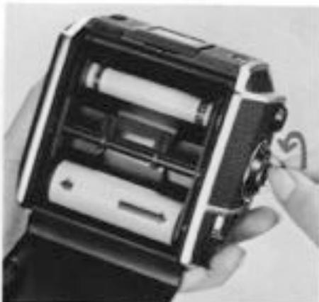
Pour avancer le film jusqu'à la première vue, tourner la manivelle dans le sens de la flèche jusqu'à ce que le nombre 1 apparaît dans la fenêtre du compteur. Quand le chiffre 1 apparaît, donner deux ou trois supplémentaires; ni le film, ni le compteur n'avanceront. Attacher le dos magasin à l'appareil pour photographier.
