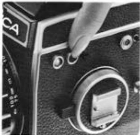
d. Pour contrôler la puissance de la pile, appuyer sur le bouton de contrôle. Si la pile est en bon état, la lampe de contrôle s'allume.
