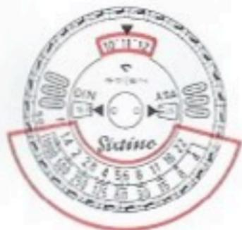
Les chiffres rouges dans la fenêtre du haut correspondent à des valeurs d'exposition; les chiffres verts dans la fenêtre du bas correspondent aux temps de pose en secondes, les chiffres noirs aux temps de pose en fractions de seconde. La série de chiffres précédée d'un « f » au-dessus correspond aux ouvertures du diaphragme. Les ouvertures de 3.6, 4.5 et 6.3 que l'on trouve sur certains appareils photographiques sont repérées ici par des points noirs.
