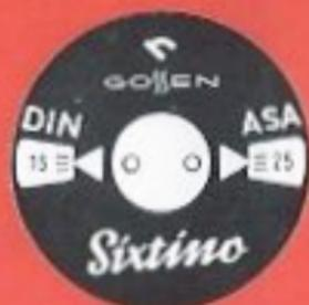
Tourner le cadran intérieur à l'aide du bouchon en plexiglas jusqu'à ce que la pointe du triangle blanc dans la fenêtre des sensibilités en DIN se trouve en face de la sensibilité de votre film en ° DIN. Si vous employez un film dont la sensibilité est indiquée en ° ASA, effectuer le réglage de la même façon, mais en se fiant aux graduations apparaissant dans la fenêtre pour les sensibilités ASA. On peut alors commencer la mesure.
