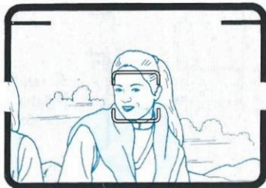
Déplacez l'appareil de telle façon que le sujet soit situé dans la plage de mise au point. Puis, appuyez **partiellement** sur le déclencheur.
