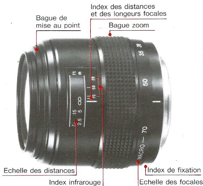
Descripción de partes: 1. Línea roja para marcar el vidrio SD. 2. Anillo de enfoque manual. 3. Escala de distancia de enfoque. 4. Tabla de distancia de enfoque. 5. Tabla de infra rojo. 6. Tabla de longitud focal. 7. Anillo zoom. 8. Escala de longitud focal. 9. Punto de montura.
